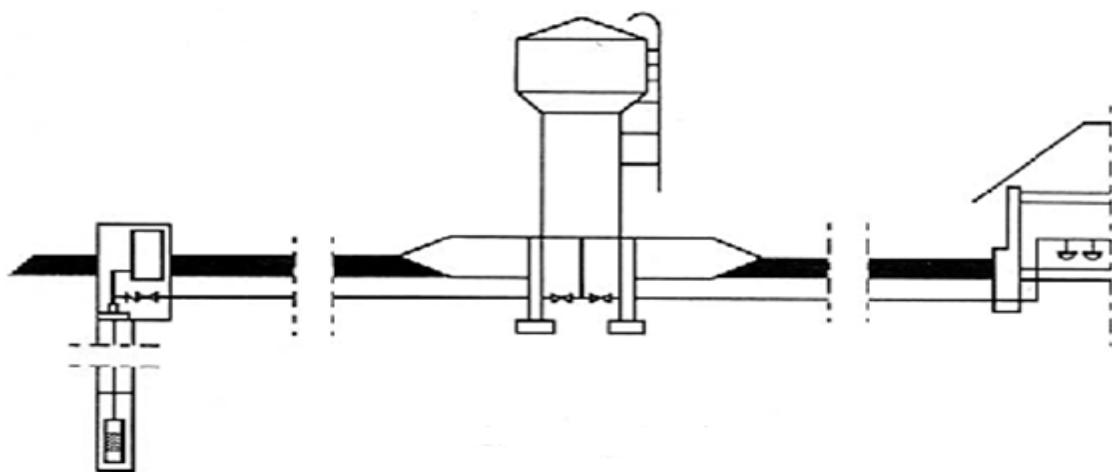
Наиболее широко применяемая система водоснабжения села – башенная. Надежная работа системы в автоматическом режиме, прежде всего, зависит от того, в какой степени учтены особенности, условия и режимы взаимного функционирования всех элементов системы: скважина, погружной насос, водонапорная башня, трубопровод, санитарно-технические приборы
